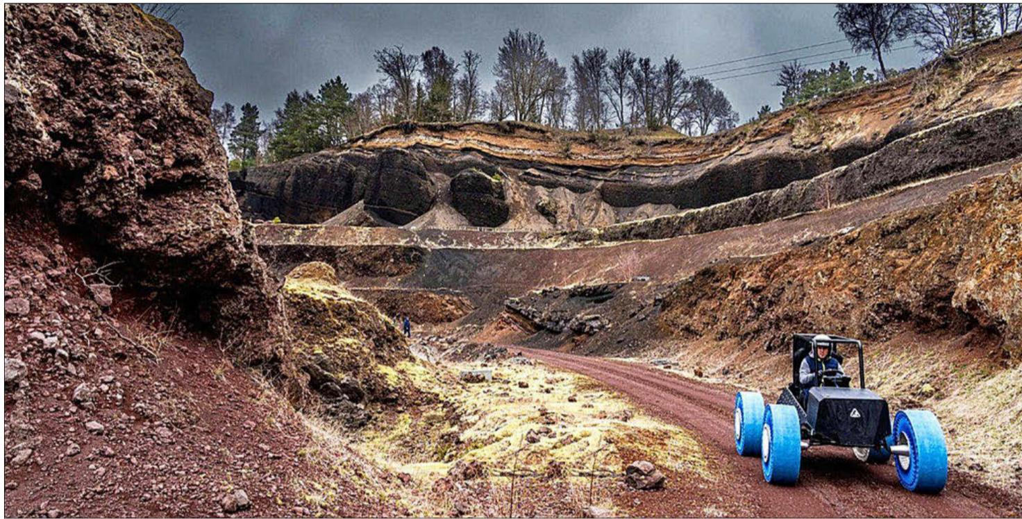
Las pruebas del neumático que usarán los vehículos de los astronautas que vayan a la Luna simulan las condiciones del satélite. MICHELIN
